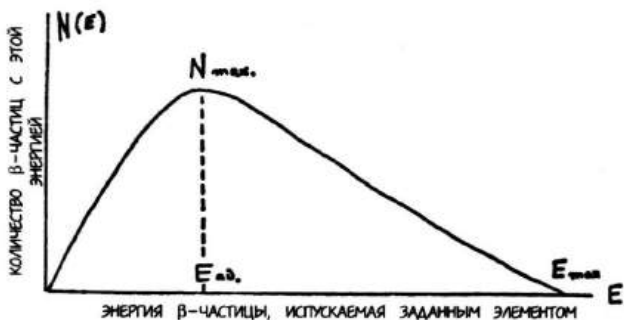
Рис. 17. Типичная кривая распределения энергии типичного \beta -излучения.
