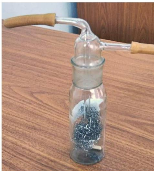
4 Стружка нержавеющей стали в каталитическом реакторе с магнитной мешалкой для газофазных и трехфазных (газообразный сероводород, твердый катализатор, жидкий растворитель) процессов
