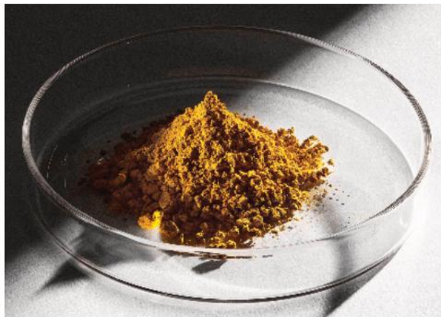
◆ Солеин — белковый порошок «из воздуха и воды» — производят микроорганизмы в биореакторе
