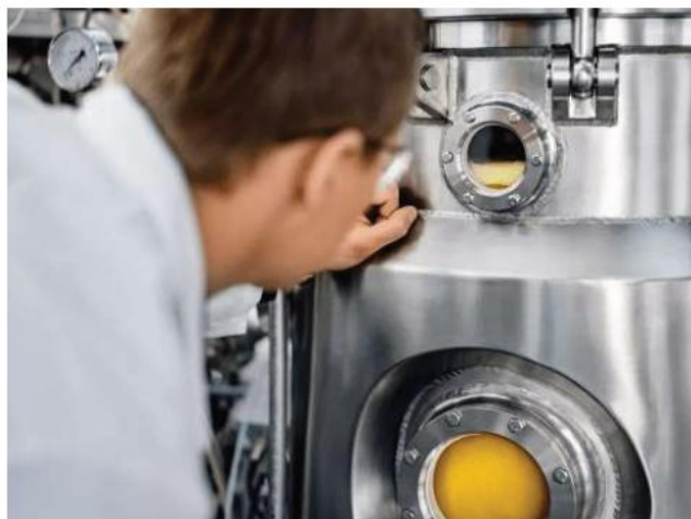
◆ Солеин — белковый порошок «из воздуха и воды» — производят микроорганизмы в биореакторе
