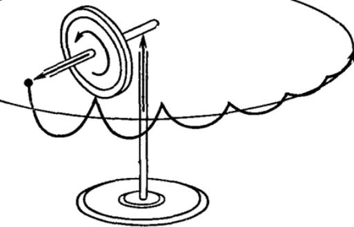
Ф и г. 20.5. Истинное движение конца оси гироскопа под действием силы тяжести тотчас же после его освобождения.
