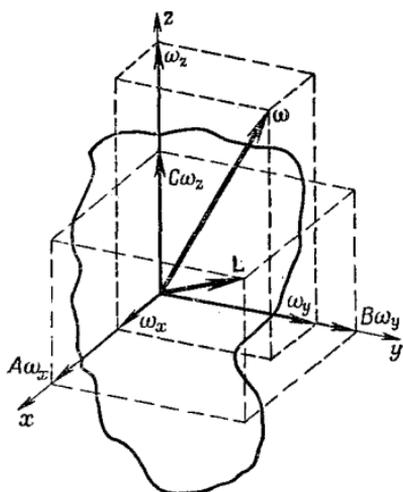
Ф и з. 20.7. Угловая скорость и момент количества движения твердого тела ( $A > B > C$ ).
