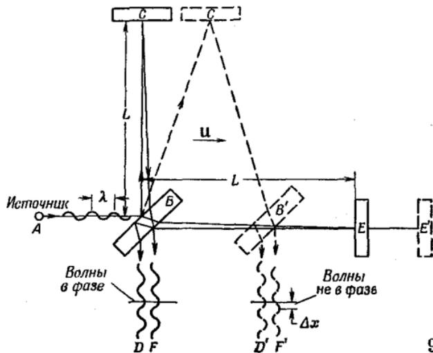
Ф и г. 15.2. Схема опыта Майкельсона — Морли.
