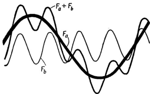
Ф и г. 25.1. Пример принципа суперпозиции для линейных систем.
